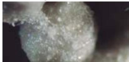
Los puentes de cristal entre las partículas del fertilizante causan compactación.
