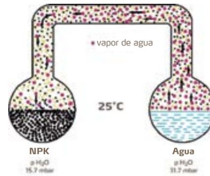
La presión de vapor de agua del aire varía con la humedad y temperatura del aire. Bajo condiciones tropicales/ de verano puede presentarse condensación. Esto tiene un impacto en la calidad del fertilizante desprotegido almacenado a granel.
