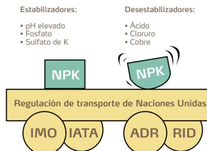
Las reacciones exotérmicas producen un aumento del calor y de los gases liberados por el fertilizante después de un periodo inicial con niveles de pH decrecientes. La velocidad de la descomposición se acelera en presencia de cloruro, sustancias orgánicas y algunos iones metálicos – en particular el cobre (Cu<sup>2+</sup>). La descomposición se ve retardada en presencia de fosfato, material carbonoso y pH elevado.
