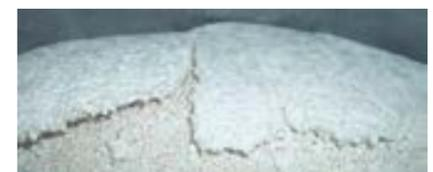
Ciclos térmicos que resultan en la desintegración del producto en la capa superior del producto almacenado.
